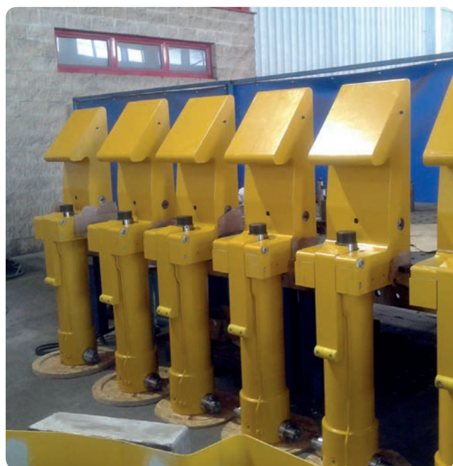
▲ Exemple de pinces-étau hydrauliques de 60T
